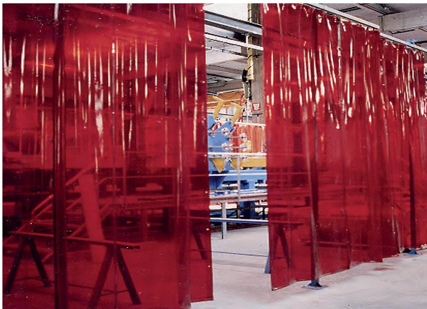
Tenda di protezione per saldatura larghezza standard 2000mm, altezza\* 1600mm e spessore 0,4mm. Dispone di occhielli rinforzati e bottoni automatici laterali per la loro giunzione. Disponibile nella colorazione classica T40 (rossa) e T75M (verde scuro, per postazioni ravvicinate o elevati amperaggi).
