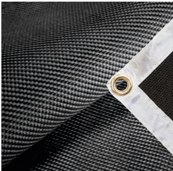
Coperta anticalore in vermiculite, robusta, trama medio ampia. Colore grafite, spessore 1,6mm, peso 875g/m<sup>2</sup>. Temperatura di servizio 750°C, limite 950°C.
