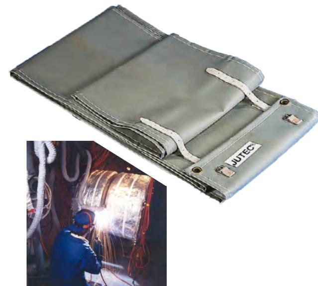
Copertura speciale di protezione per il raffreddamento controllato delle saldature nei tubi. Previene dagli shock termici e protegge da agenti esterni il cordone di saldatura. Sistema di aggancio e sgancio rapido con cinghia e fibbia di fissaggio. Rivestito esternamente in poliuretano idrorepellente, tessuto interno resistente fino a 600°C. Larghezza standard 300mm, diametri variabili da 200 a 1400 mm
