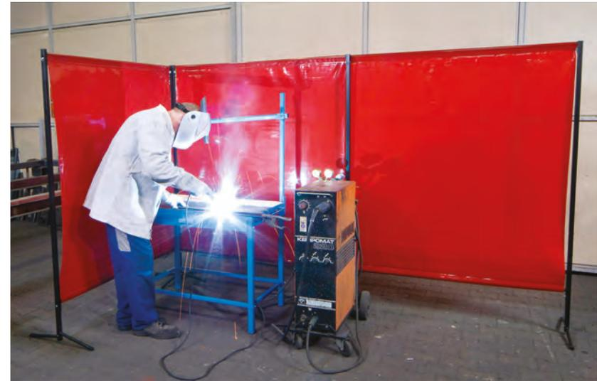
Schermo di protezione mobile in kit d'assemblaggio composto da struttura leggera in tubolare a sezione quadrata, piedini a T e tenda unica, fissata alle doppie barre orizzontali tramite doppio bordo superiore ed inferiore. Piedini predisposti per accostamento in serie. Altezza 2 mt, larghezze disponibili 1460 e 2000 mm spessore 0,4 mm.
