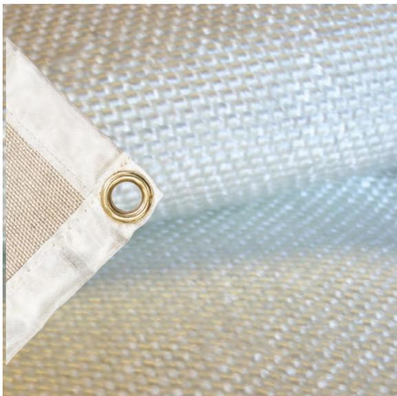
Coperta anticalore in fibra di vetro medio leggera con cuciture laterali e occhielli. Colore bianco spessore 0,75mm, peso 610g/m<sup>2</sup>. Temperatura di servizio 550°C, limite 700°C.
