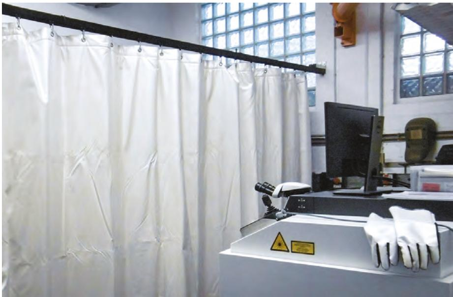
Per la protezione passiva e la realizzazione di barriere laser proponiamo diverse soluzioni prodotte dall'azienda tedesca Jutec, garantendo così competenza e qualità. In tutti gli ambienti di saldatura con applicazione Laser ma anche medicali, laboratori, è indispensabile l'utilizzo di ripari adeguati che blocchino totalmente le radiazioni emesse dalla fonte. In funzione del livello di protezione, sono disponibili delle tende laser in diversi materiali:
